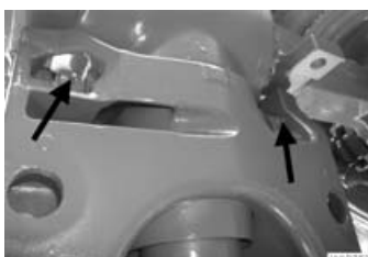
Hefcilinderlager van de voorasvering beneden
