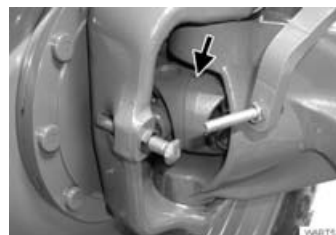
Dubbele kruiskoppeling van de voorwielaandrijving
